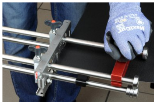
Para la fabricación del perfil de la junta alzada de doble engatillado
