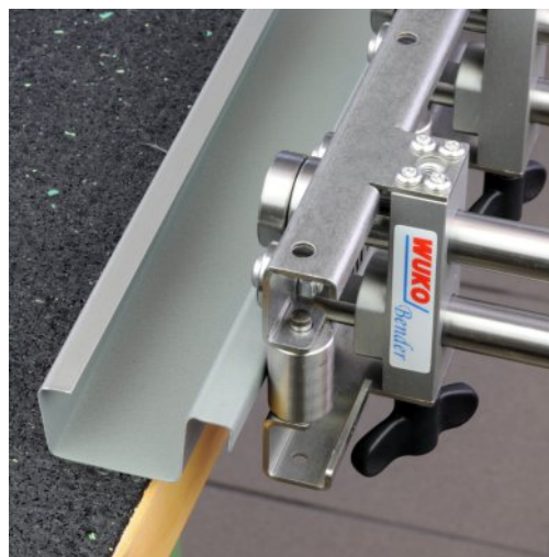
Para la fabricación del perfil de la junta alzada de doble engatillado
