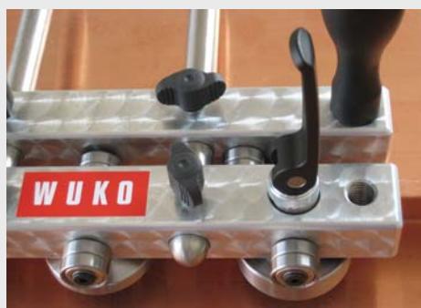
Sistema de la palanca de excéntrica
