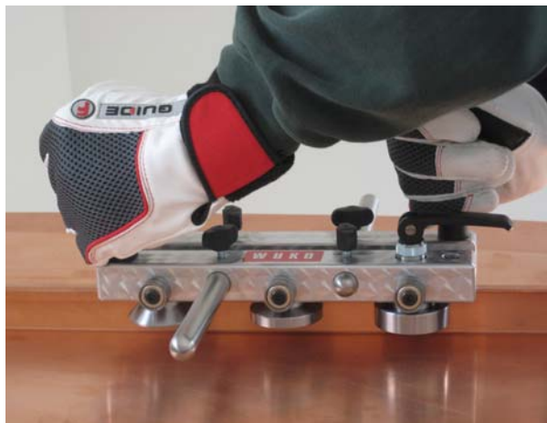
Deslizar la herramienta usando los mangos
